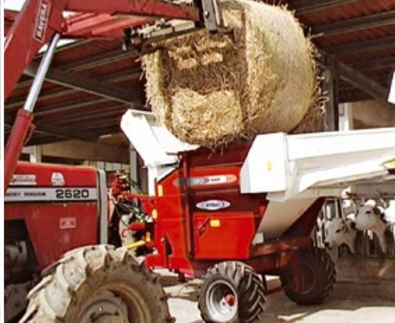
Gli sfaldatori SBQI Bicieffe possono contenere un ballone di qualsiasi misura nel modello 1480 e due balloni (max 70x120) nel modello 1780. Variando la velocità di srotolamento possono essere utilizzati sia rotoballe di paglia sia di stocchi di mais (non funzionano con rotoballe di fieno).
