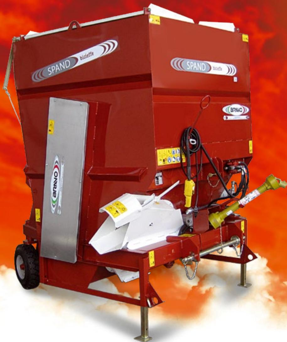
Gli spandisegatura serie SPAND Bicieffe 36 distribuiscono in modo ottimale e uniforme i diversi tipi di segatura, il separato umido, la paglia trita. La distribuzione viene effettuata con una turbina che lavora senza immissione di aria in modo da contenere l'emissione di polvere ad un livello ampiamente accettabile.
